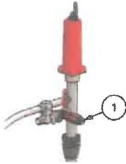
Retirez le tuyau pression de l'appareil et dévissez la bride du tuyau d'aspiration à l'aide d'un tournevis approprié 1.
