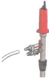
Retirez le tuyau d'aspiration de l'embout sur l'injecteur.
